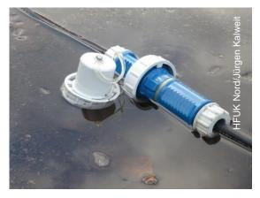
Alle im Einsatz- und Übungsdienst der Feuerwehr verwendeten ortsveränderlichen elektrischen Betriebsmittel müssen, wenn mit einem zeitweiligen Eintauchen der Steckvorrichtungen in Flüssigkeiten zu rechnen ist, mit druckwasserdichten Steckvorrichtungen (DIN 49442, DIN 49443, DIN EN 60309 – IP 67) ausgestattet sein.
