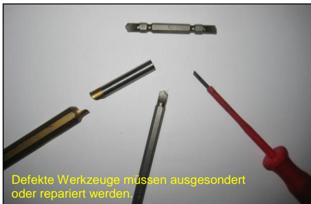
Sicherheitstechnisch nicht einwandfreie Werkzeuge, insbesondere Hämmer, Schraubendreher, Schraubenschlüssel und Meißel, sind unverzüglich in Stand zu setzen.
