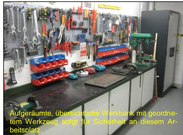
Aufgeräumte, übersichtliche Werkbank mit geordnetem Werkzeug sorgt für Sicherheit an diesem Arbeitsplatz.
