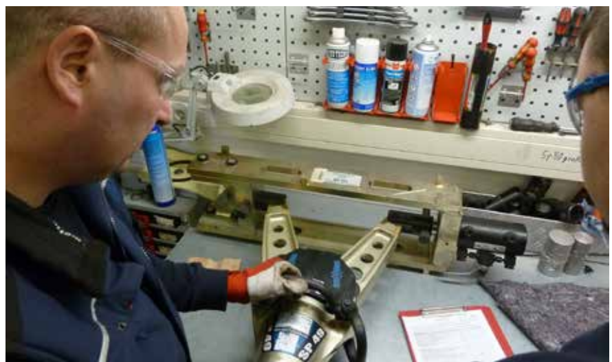
►► Prüfung eines hydraulischen Spreizers
