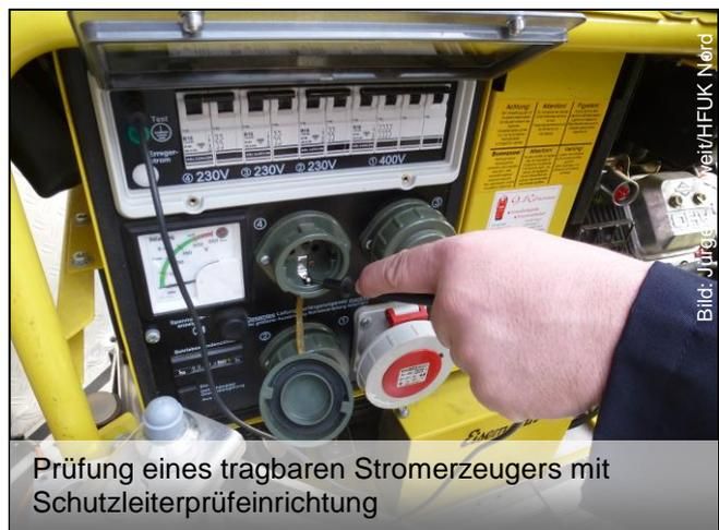
Prüfung eines tragbaren Stromerzeugers mit Schutzleiterprüfeinrichtung
