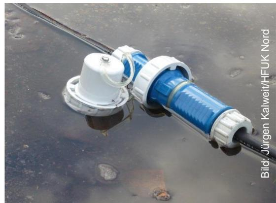
Alle im Einsatz- und Übungsdienst der Feuerwehr verwendeten ortsveränderlichen elektrischen Betriebsmittel müssen, wenn mit einem zeitweiligen Eintauchen der Steckvorrichtungen in Flüssigkeiten zu rechnen ist, mit druckwasserdichten Steckvorrichtungen (DIN 49442, DIN 49443, DIN EN 60309 – IP 67) ausgestattet sein.
