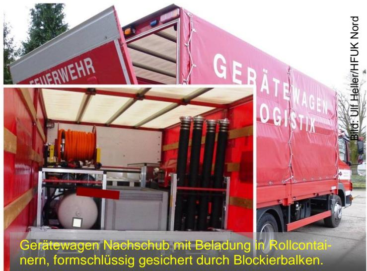
Der Vorteil der Logistikfahrzeuge liegt in der hohen Flexibilität hinsichtlich der Beladungs- und somit Einsatzmöglichkeiten. Ein weiterer Vorteil ist, dass es aus dem Güterkraftverkehr gute und geeignete Lösungen zur Ladungssicherung gibt. Neben dem Verwenden von Material zum Niederzurren und dem Herstellen des Formschlusses empfehlen sich auch Antirutschmatten zur Erhöhung des Reibwertes.
