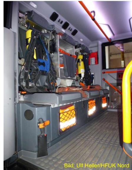
Zum Schutz der Besatzung ist in Feuerwehrfahrzeugen eine physikalische Trennung oder sichernde Vorrichtung für die gelagerte Ausrüstung vorgeschrieben, die bei einem Unfall oder während einer Notbremsung eine negative Beschleunigung von 10 G in Fahrtrichtung aufnimmt.
