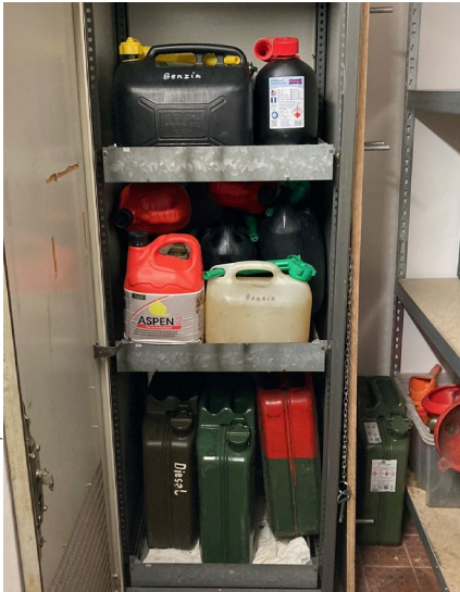
» Lagerung von Gefahrstoffen in einem Gefahrstofflagerschrank
