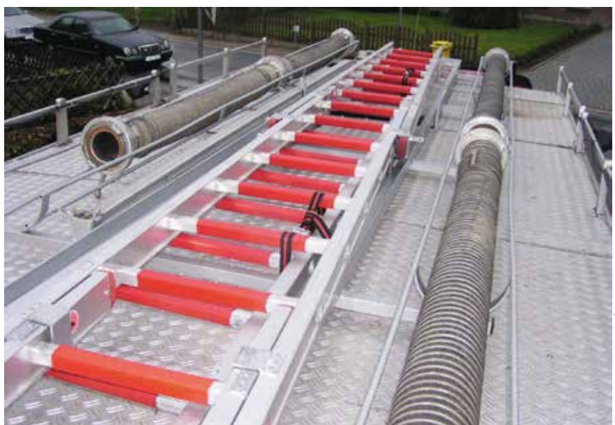
► Falsch angeordnete Verkehrswege – Leiter ohne korrekte Halterung
