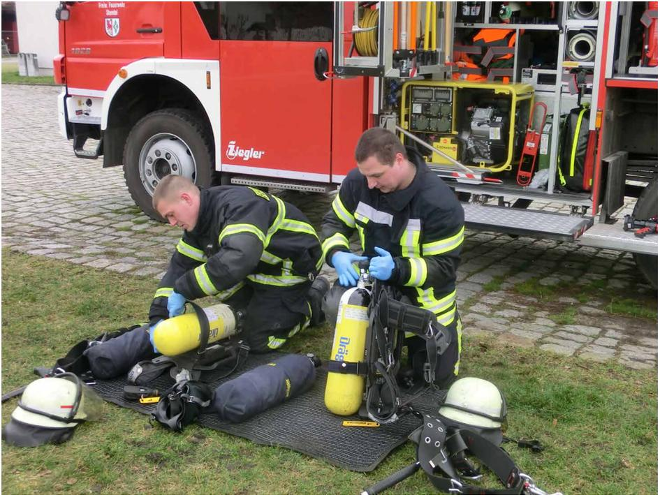
Eine Einsatzkurzprüfung ist also vor jedem Einsatz, aber auch vor einer Übung und nach einem Wechsel der Druckluftflaschen oder des Lungenautomaten durchzuführen. Sie besteht aus:
