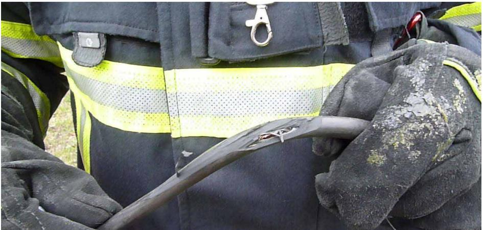
Die Prüfung elektrischer Geräte durch Feuerwehrangehörige, die in der Regel elektrotechnische Laien sind, also keine elektrotechnischen Kenntnisse wie Elektriker oder Elektrikerinnen haben, beschränkt sich auf die Sicht- und Funktionskontrolle mit dem Ziel, die elektrische Sicherheit zu gewährleisten. Das heißt, den Schutz gegen die Gefahren durch elektrische Durchströmung des menschlichen Körpers oder durch Folgen von Störlichtbögen sicherzustellen.
