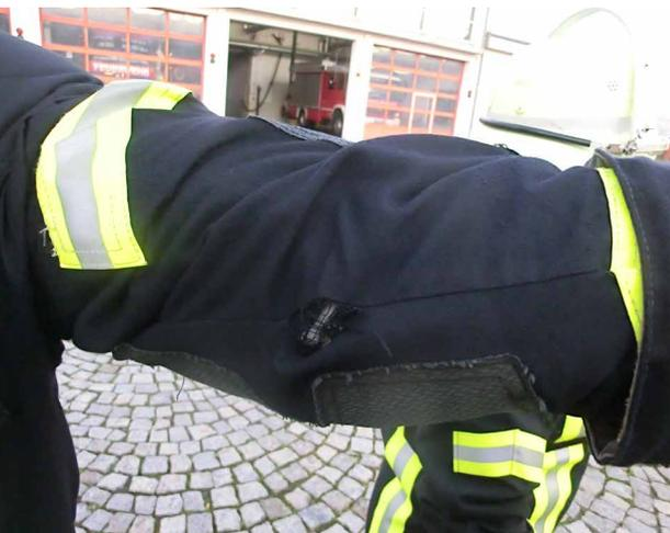
Schutzausrüstungen sind nach jeder Benutzung einer Sichtprüfung zu unterziehen. Diese Prüfung trägt dazu bei, dass die Schutzausrüstungen im Einsatzfall wieder sicher und betriebsbereit sind. Sie kann von jeder bzw. jedem Feuerwehrangehörigen durchgeführt werden, die bzw. der im Umgang mit diesen Ausrüstungen, Geräten und Schutzausrüstungen vertraut ist.
