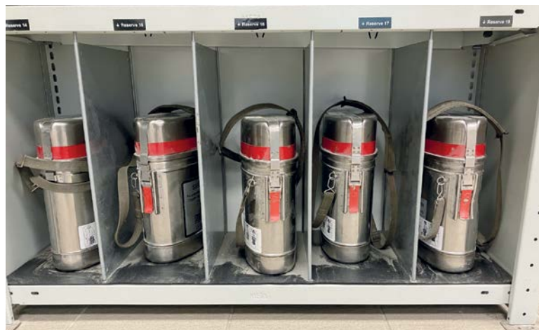
Abbildung 2 – Beispielhafte Lagerung von SSR in einem Regal
