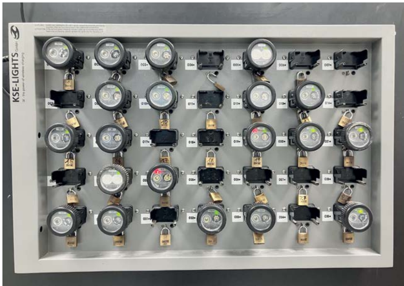
Abbildung 3 – Lagerung von Helmlampen mit LIB in einer Ladestation
