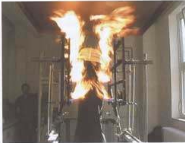
Beflammung eines Feuerwehrhelmes (Foto DMT)
