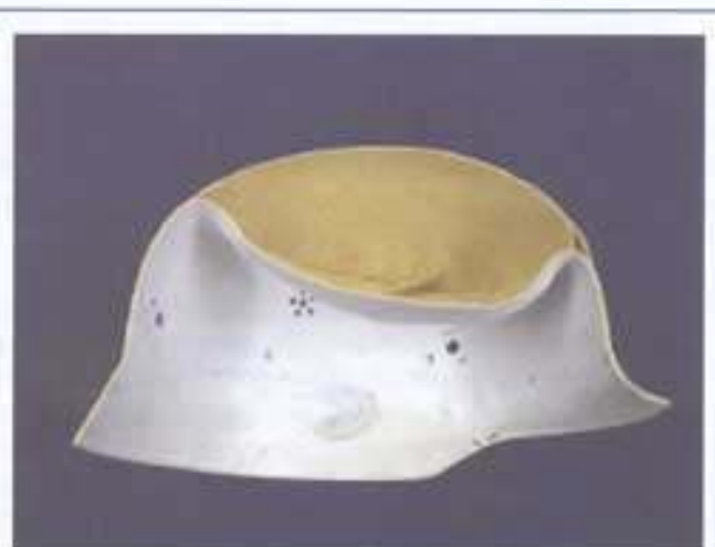
Die Ausgangslage: Blasenbildung an einem Helm (Schnittansicht) aus PF-SF (Bild FUK Nord)
