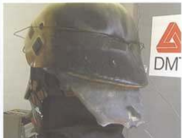
Nackeneder und Helm nach Beflammung (Foto DMT)
