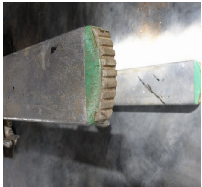
▶ Der verhärtete nicht mehr rutschhemmende Leiterfuss als Teil der Unfallsache.
