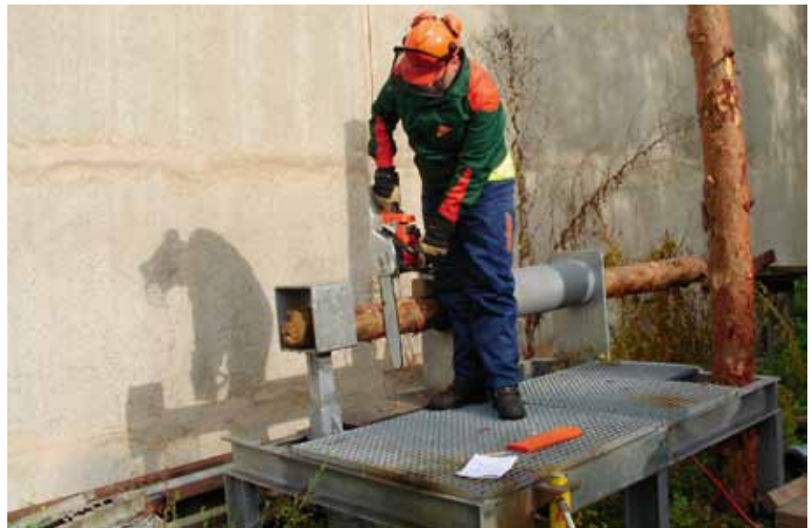
Schneiden von unter Spannung stehendem Holz an einem Baumbiege-Simulator
