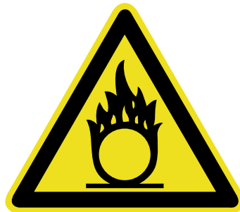
W11 Warnung vor brandfördernden Stoffen
