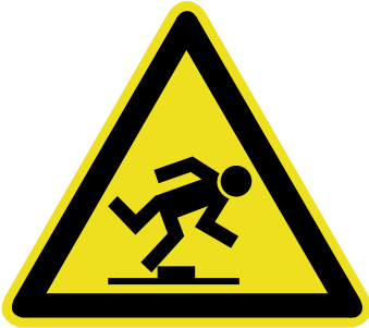
W14 Warnung vor Stolpergefahr
