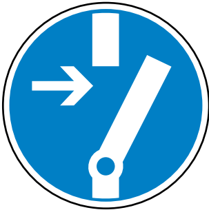
M14 Vor Arbeiten freischalten
