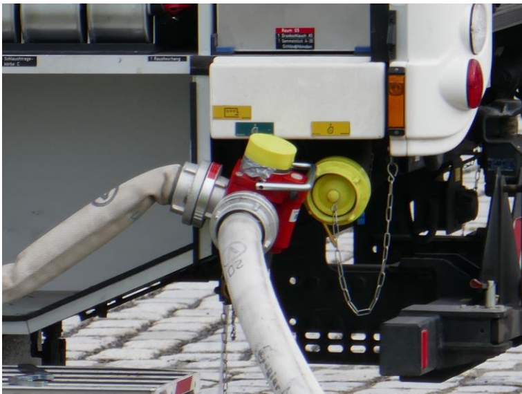
Bild 13: Am Fahrzeug angeschlossenes Druckbegrenzungsventil
