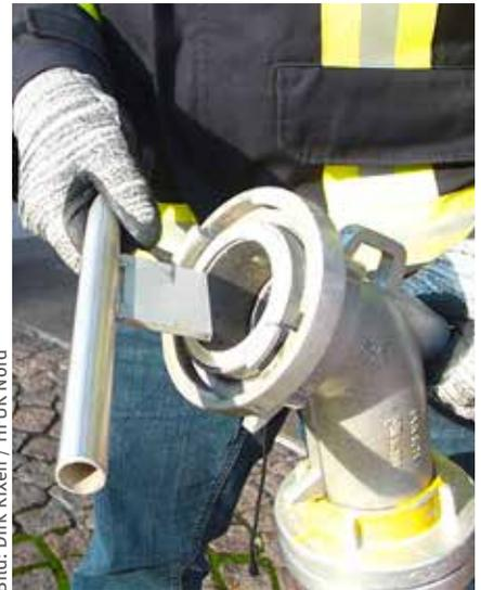
▶▶ Werkzeug zum Festziehen des Gewindestutzens im Stützkrümmer
