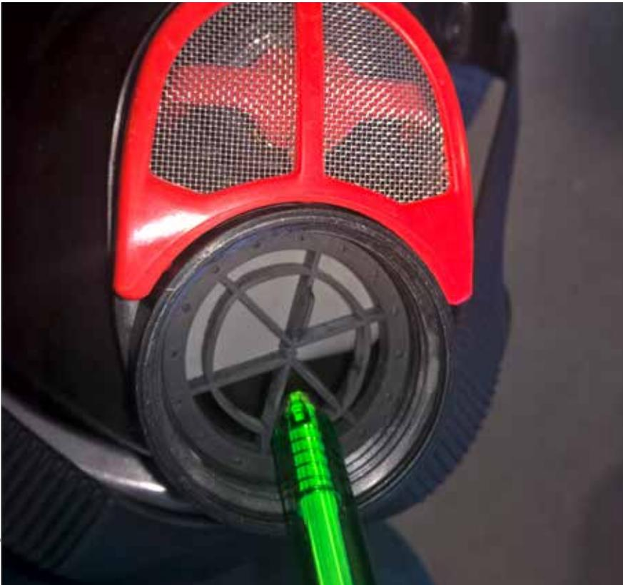
» Ein verklebtes Einatemventil führte durch Querschnittsverringering zu erheblichem Einatemwiderstand
