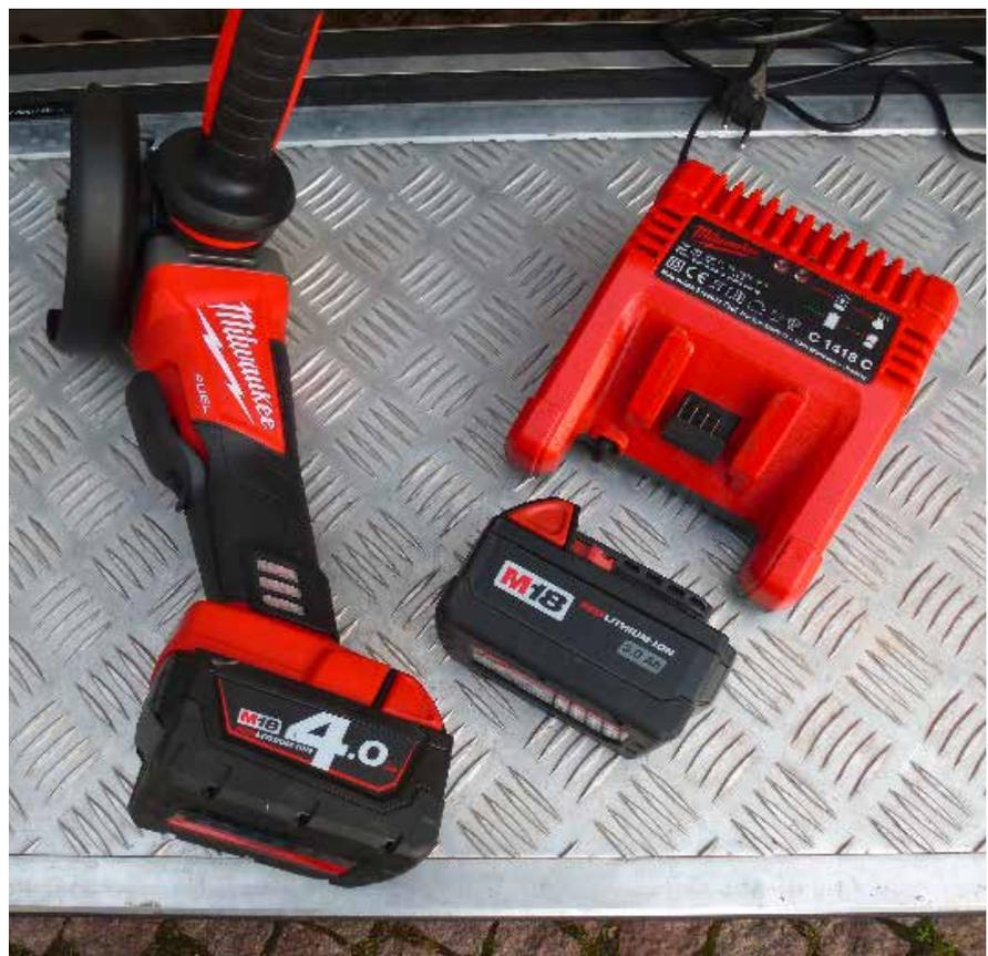
▶ Lithium-Ionen-Akku und Ladegerät eines Trennschleifers
