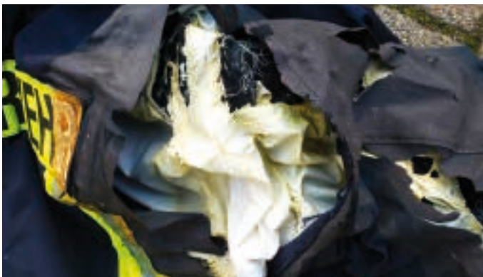
▶ Zweck eindeutig erfüllt! Die Feuerwehrjacke des Atemschutzgeräteträgers wurde zwar völlig zerstört, verhinderte jedoch schlimme Verletzungen.
