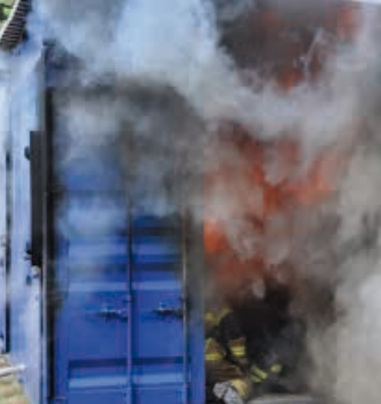
► In dieser feststoffbefeuchten Übungsanlage wird eine Rauchgasdurchzündung dargestellt.
