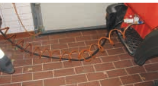
► Dieses Ladekabel versperrt den Verkehrsweg.
