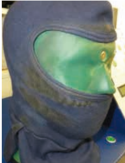
▶ An der Flammenschutzhaube sind deutliche Spuren von Wärmebeaufschlagung erkennbar.
