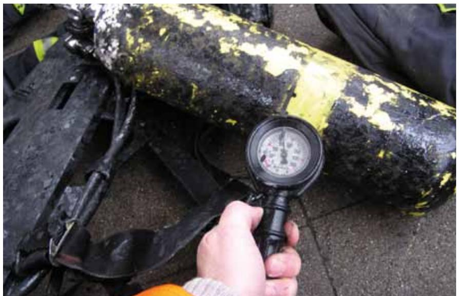
Das beaufschlagte Atemschutzgerät blieb funktionstüchtig. Das Manometer zeigte noch 160 bar an.
