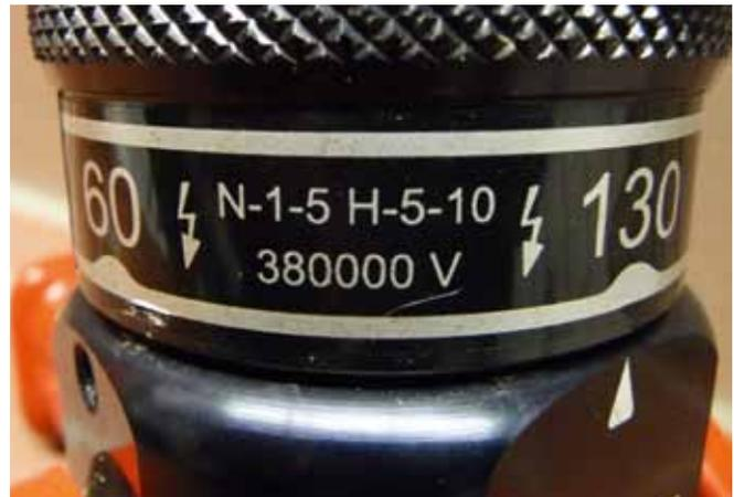
Schutzabstände, wie sie die DIN VDE 0132 vorsieht, auf einem Hohlstrahlrohr abgebildet
