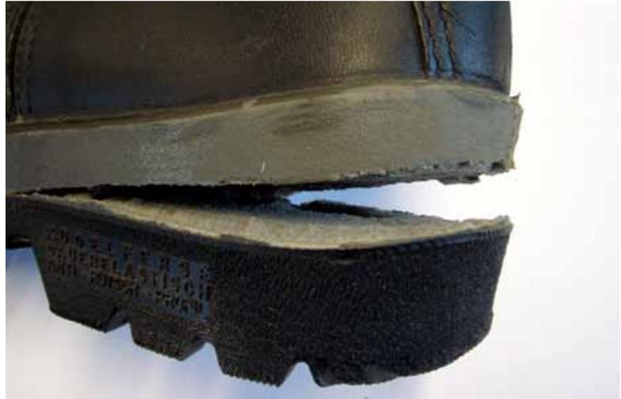
Feuerwehrstiefel, 14 Jahre alt. Die Sohle löste sich unverhofft beim Hinhocken während eines Einsatzes. Der Anruf eines Vertreters der Herstellerfirma ergab, dass mit dem plötzlichen Versagen von Materialien gerechnet werden muss, wenn diese ein gewisses Alter erreichen. Dies hängt insbesondere auch von den eingesetzten Materialien ab. Er war erstaunt, dass 14 Jahre alte Feuerwehrstiefel noch eingesetzt werden.
